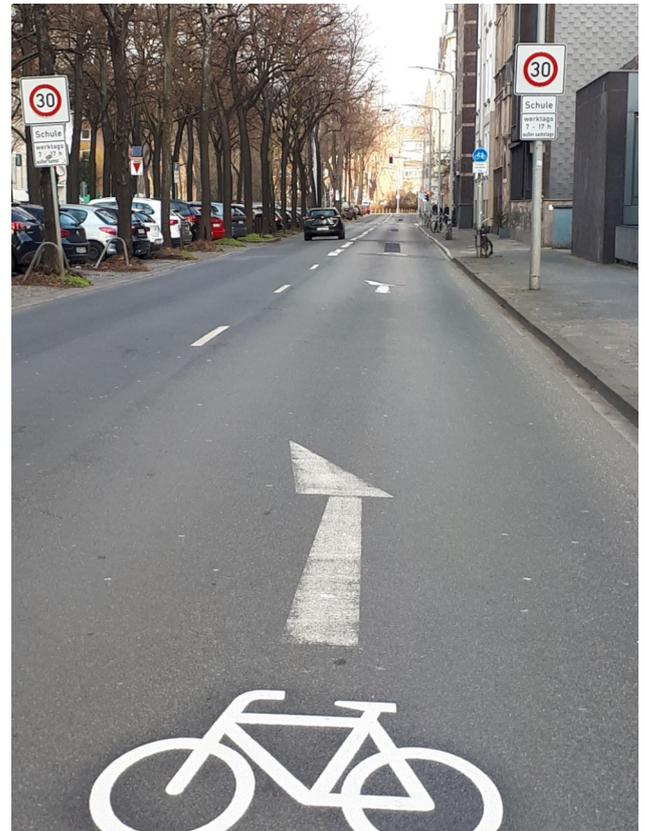
Vor Beginn des neuen Radstreifens ist ein Piktogramm vor den anschließenden Abbiegepfeil neu aufgebracht – so als sollten Radfahrende nach links auf die Kfz-Spur wechseln.
