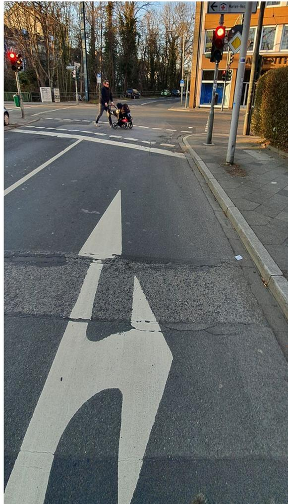
An der Moltkestraße endet der Radfahrstreifen dann unvermittelt. Es fehlt an einer klaren, geführten Einmündung in den alten Radweg vor oder hinter dem Kreuzungsbereich sowie an einer klaren Routenführung für Linksabbiegende.
