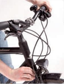
Ein lockerer Steuersatz stört das Fahrverhalten und geht schnell kaputt. Stellen Sie sich neben das Rad, ziehen Sie die Vorderradbremse und schieben Sie dabei das Rad vor und zurück. Gleichzeitig nehmen Sie die untere Lagerschale zwischen Daumen und Zeigefinger. Spüren Sie ein Rucken, muss der Steuersatz nachjustiert werden.
