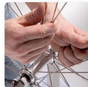
Hat die Felge einen Schlag? Halten Sie einen Schraubenzieher so, dass die Spitze etwa zwei Millimeter Abstand zur Felge hat und drehen Sie das Rad. Sind deutliche Ausschläge zur Seite zu sehen oder schleift die Felge sogar am Bremsklotz, sollte das Laufrad zentriert werden.
